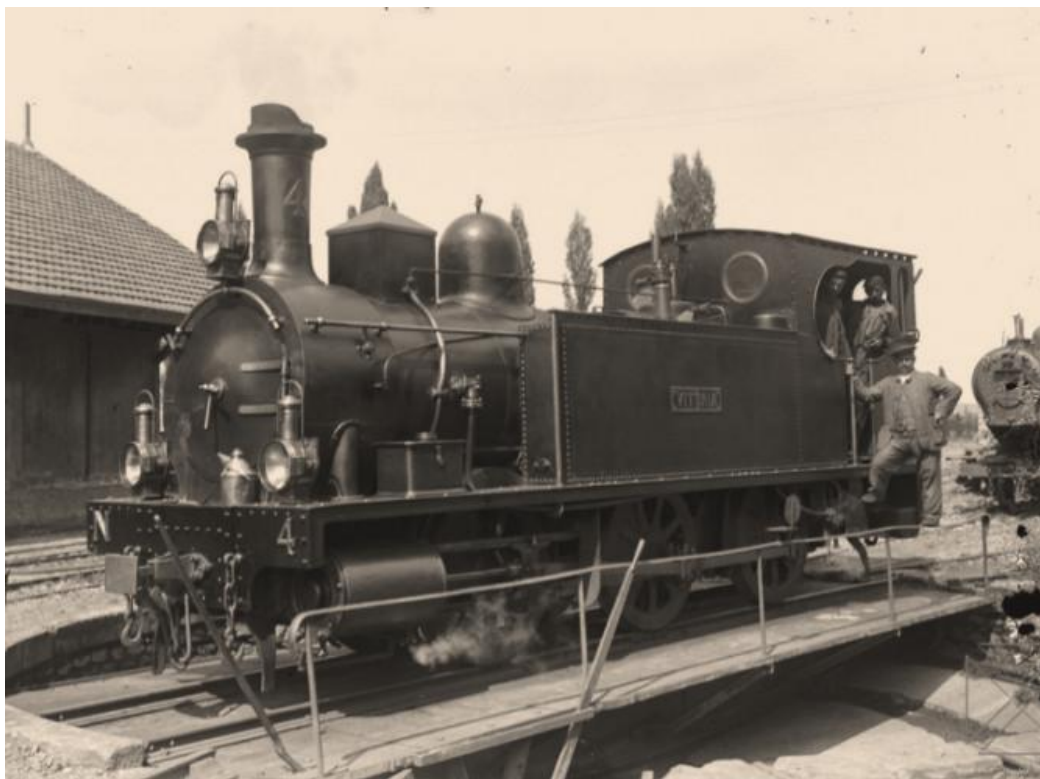
Locomotora «Vitoria» nº 4 Falcon rodaje 030T, Foto; E. Guinea Archivo Municipal de Vitoria Gasteiz (GUI III-095.04)
