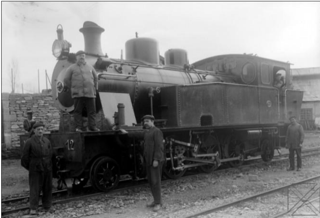
Locomotora nº 12, MTM rodaje 131T, entregada en 1922, Foto; E. Guinea Archivo Municipal de Vitoria –Gasteiz (GUI VII-124.09)
