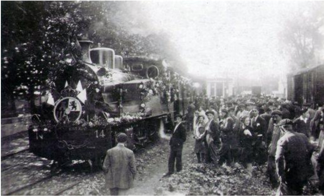
Tren inaugural de la sección de Vitoria a Estella, abierta al servicio el 23 de Septiembre de 1927. la locomotora de vapor nº 14, una robusta máquina del tipo 131T (Prairie) fabricada por La Maquinista Terrestre y Marítima (MTM) en Barcelona.
